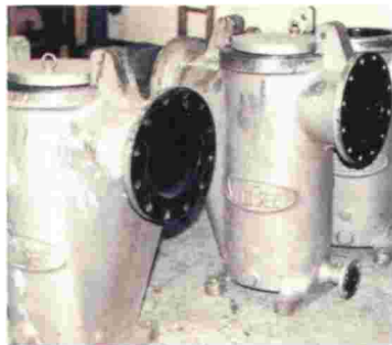
REVESTIMIENTO DE CUBIERTAS DE FILTROS
