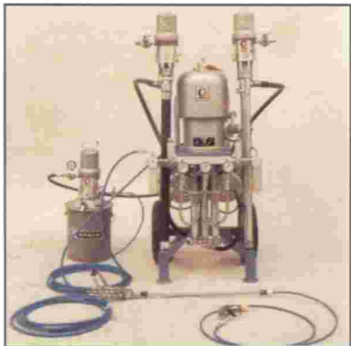
EQUIPO TÍPICO PARA ROCEAR EL BELZONA® 1522
