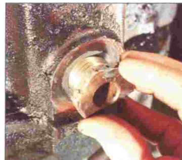
RECONSTRUCCION DE ROSCAS DESGASTADAS
