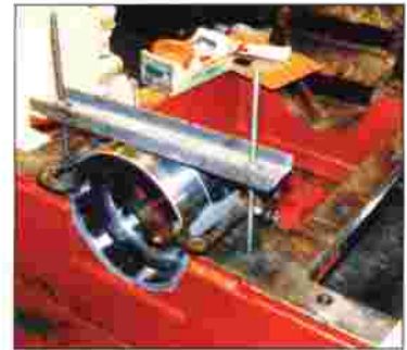
RECTIFICACION DE ASIENTOS DE COJINETES
